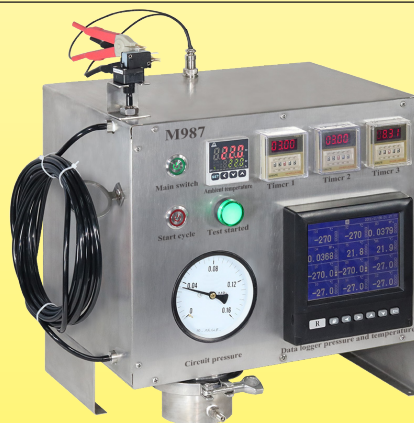
根据推动按钮的体积及其产生的压力反复不断地测量空气开关连接管的最大长度的测试设备 (Ultimheat 实验室)
